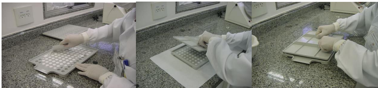
Figura 6, 7 e 8. Preenchimento das cavidades e compactação
